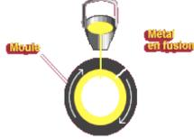
A - Le métal en fusion est coulé dans un moule cylindrique en rotation.
