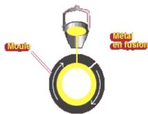
A - Le métal en fusion est coulé dans un moule cylindrique en rotation.
